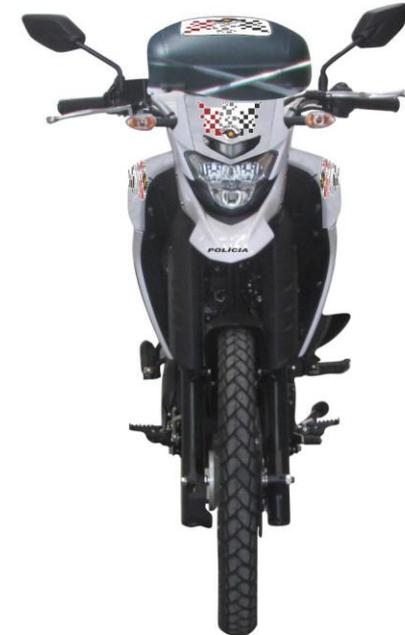
A aplicação do grafismo segue o padrão PMESP, sendo adesivos em material de alta performance para impressão digital, laminação e refletivo com proteção UV.
