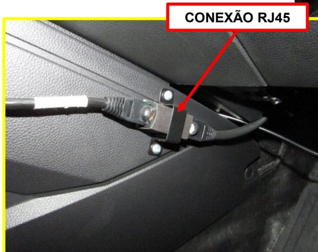
O veículo é equipado com preparação para Rádio Comunicador modelos Teltronic MDT400 e M4000U UHF e VHF, com suporte fixado no painel do veículo. A Caixa de Áudio fica instalada abaixo do porta-luvas e é conectada diretamente no Rádio Comunicador.
