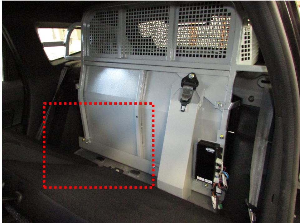
O veículo possui Sensores de Estacionamento no para-choque traseiro com display digital sonoro instalado no lado esquerdo do painel, os sensores são capazes de detectar objetos à uma distância máxima de 1,5m. O módulo dos sensores está instalado na lateral esquerda do Compartimento de Detidos, podendo ser acessado pela tampa de inspeção do revestimento.
