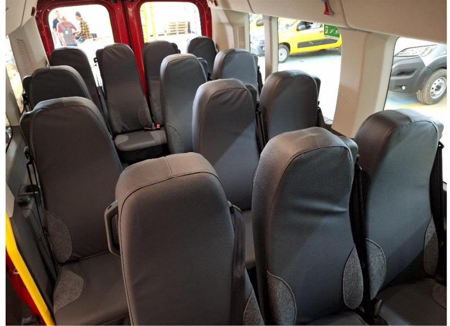
Os bancos do veículo são revestidos com Courvin Automotivo Cinza Antichama Removíveis, dotado de pontos de resistência nas laterais dos encostos e dos assentos), onde o armamento portado pelos policiais mantêm contato com o banco, seguindo o padrão PMESP.
