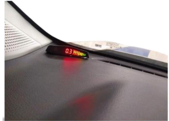
1. Com o carro ligado, ao engatar a marcha ré, os quatro sensores traseiros originais serão energizados e, por sua vez, passarão a medir a distância dos obstáculos. Os sensores dianteiros permanecerão inertes nesse momento.
