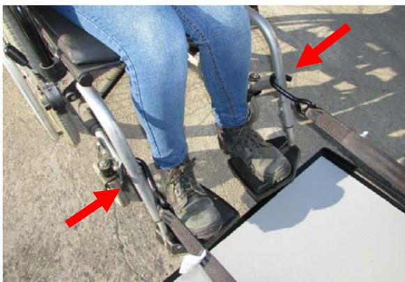
8. Engate os ganchos dos cintos nas estruturas frontais da cadeira de rodas sendo em um local fixo e reforçado.
