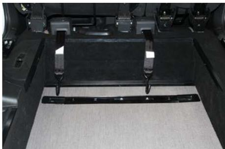
3. Retire os suportes puxando para cima e guarde-os nas bolsas e nas redes laterais do compartimento.
