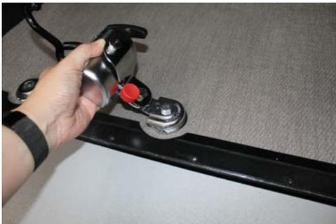
1. Encaixe os retratores lateralmente nas travas fixas do assoalho.
