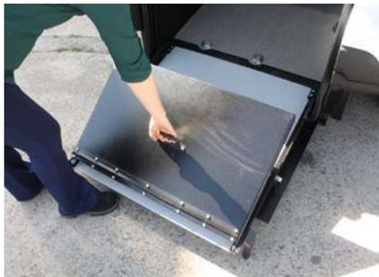
3. Levante a alça de apoio da segunda parte da Rampa e desdobre a segunda parte até a metade do percurso.
