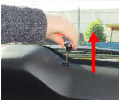
1. Pelo lado interno do compartimento de transporte da Pessoa Cadeirante, puxe a alavanca localizada no acabamento interno, posicionando-a para cima para liberar o trinco.
